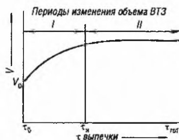
Рис. 40. Изменение объема ВТЗ в процессе выпечки
