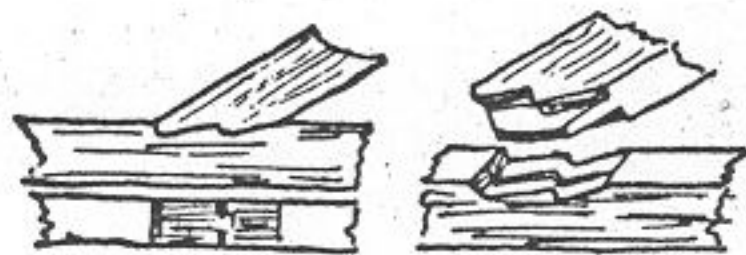
Сложный стропильный замок с двумя зубьями в один шип
