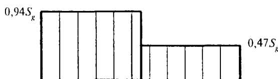
Рис. 10.7. Неравномерное (по прямоугольнику) распределение снега на покрытии
