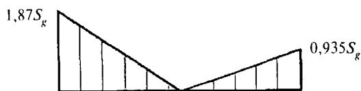
Рис. 10.6. Неравномерное (по треугольнику) распределение снега на покрытии
