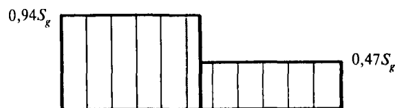
Рис. 5.5. Неравномерное (по прямоугольнику) распределение снега на покрытии
