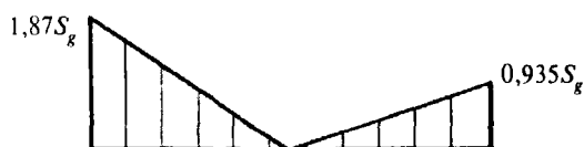
Рис. 5.4. Неравномерное (по треугольнику) распределение снега на покрытии
