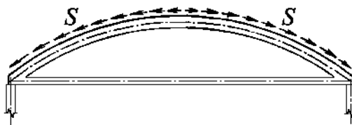
Рисунок 9.9. Схема передачи усилий с оболочки на диафрагму
