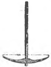
Деревянная кирка для подбивки шпаль.
