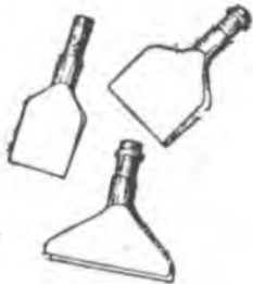
Конопатки: разбивная, наборная, доросникъ.
