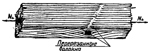
Фиг. 11. Ослабление кромки растянутого элемента
