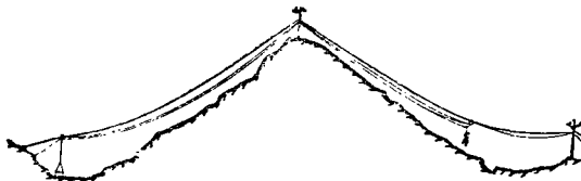
Фиг. 19. Облегченная воздушно-канатная дорога системы «Лиджервуд»; подтаска через холм
