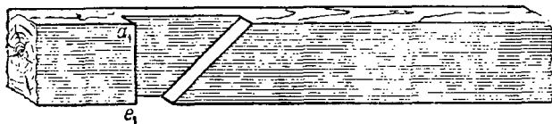
фиг. 24. Ножничная врубка без накопечника
