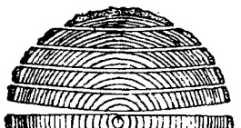
Фиг. 4. Коробление древесины
