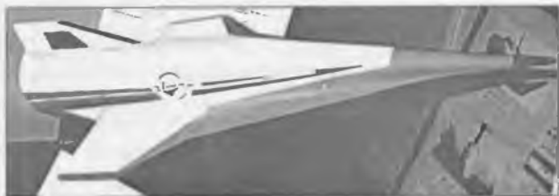
Беспилотный аппарат ГЭЛА для испытаний гиперзвуковых авиадвигателей (МАКС-95)
