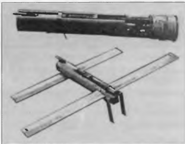
ДПЛА Р90 (транспортная и полетная конфигурации)
