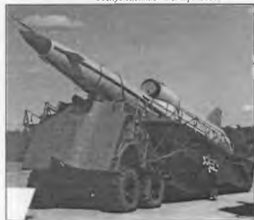
Транспортно-пусковая установка ТПУ-141 (положения "под обслуживание" и стартное)
