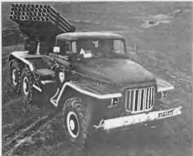
Боевая машина БМ-21 на шасси автомобиля ЗИЛ-131 (сверху), на шасси автомобиля "Урал-375Д" (справа)
