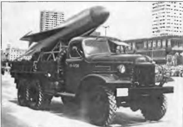
Транспортная машина для перевозки ракет типа П-15 на базе автомобиля ЗиЛ-151 (Польша, 1980-е годы)
