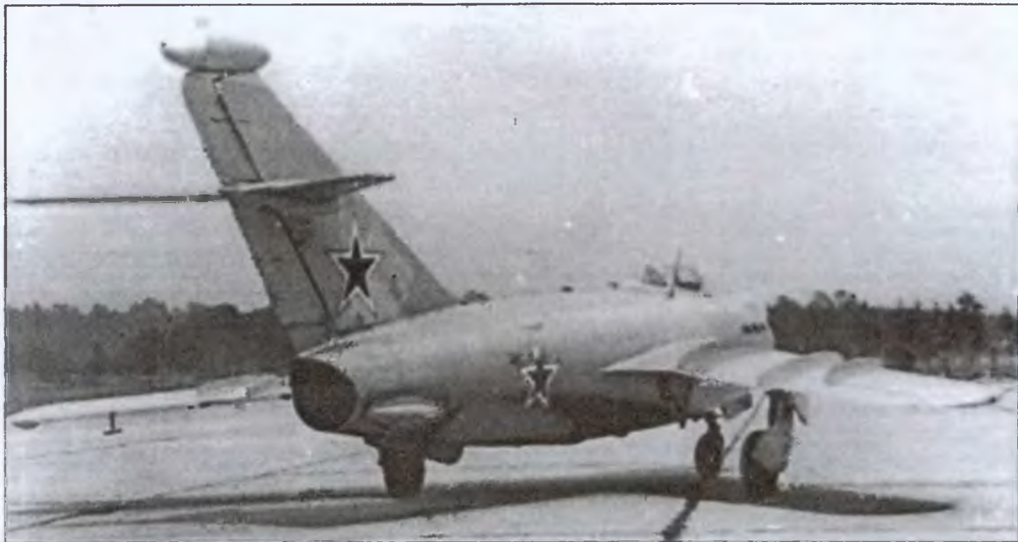
Летающая лаборатория МиГ-17СДК для отработки системы самонаведения крылатой ракеты
