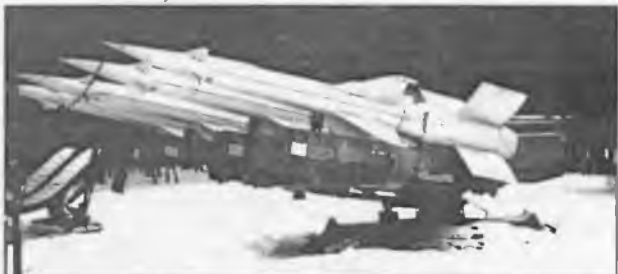
Габаритно-весовые макеты ракет 5В27 на двухбалочной пусковой установке 5П71 ЗПК С-125 "Нева"
