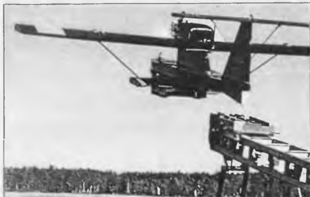
Дистанционно пилотируемый самолет "Гном-2" (бросковые испытания с катапульты; на ДПС не установлен руль направления)
