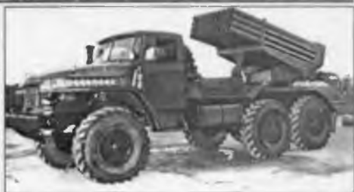
Боевая машина БМ-21 на шасси автомобиля ЗИЛ-131 (сверху), на шасси автомобиля "Урал-375Д" (справа)
