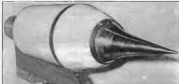
Беспилотный аппарат ГЛЛ-8 для испытаний гиперзвуковых авиадвигателей (представлен на МАКС-97)
