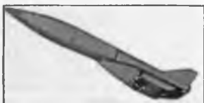
Проект беспилотного аппарата для испытаний гиперзвуковых авиадвигателей (МКБ "Радуга" - ЦАГИ, МАКС-97)
