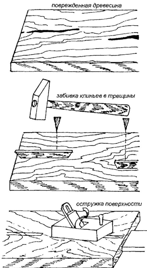
Рис. 8. Заделка трещин
