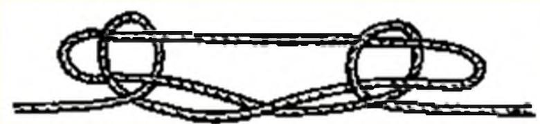
Бытовое же предназначение узла – сократить верёвку, не разрезая её. Он используется для натягивания верёвок, скрепляющих повозку, для укрепления ослабленного участка перевязи и т. д. Одно из преимуществ такого узла состоит в том, что его можно завязать посередине верёвки, не берясь за концы. При завязывании главное – не ослаблять натяжения.
