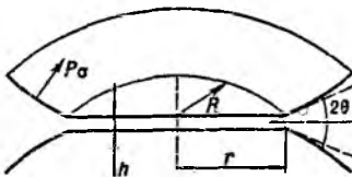
Сечение цилиндрич. тонкой пленки, находящейся в контакте с мениском объемной фазы. h -толщина пленки, R -радиус, \theta -контактный угол, P_c -капиллярное давление в канале Гиббса-Плато.
