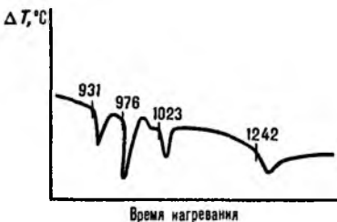
Кривая ДТА сверхпроводника Nb 3 Sn 0,85 . Числа обозначают т-ру печи (°С), скорость нагревания 10 °С/мин.
