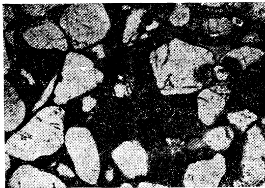
Рис. 58. Киммерийский табачный песчаник. Белое — кварц; цемент — ожелезненный сидерит. Скв. 45, гл. 27,0. Проходящий свет. Ув. 60
