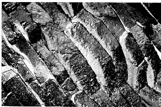
Рис. 86. Электронно-микроскопический снимок пластинчатого слоя жемчуга. Вид в сечении. Ув. 3000
