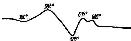
Рис. 59. Кривая нагревания сидерито-глинистого цемента табачного песчаника; скв. 45, гл. 27,0 м
