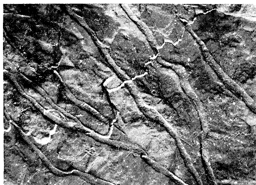
Рис. 85. Электронно-микроскопический снимок колломорфного слоя жемчуга. Ув. 3500
