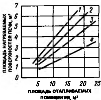
Рис. 9.5. График для подбора печей 1 — прихожая; 2 — помещения с двумя углами; 3 — помещения с одним углом; 4 — неугловые помещения
