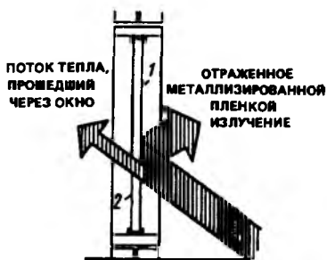
Рис. 6.21. Установка металлизированной пленки 1 — стекло, покрытое металлизированной пленкой; 2 — стекло из плекки
