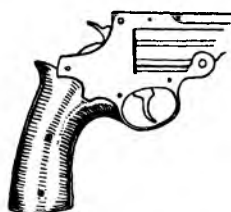
Р и с. 93. Различные дополнительные накладки и сменные рукоятки для оружия, имеющие целью удобное и однообразное расположение пальцев.
