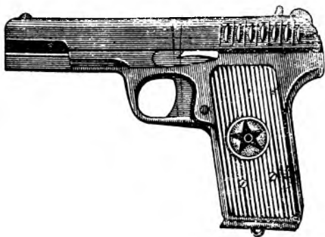
Р и с. 33. Пистолет военного образца сист. Токарева („ТТ“) 1933 г. (СССР), кал. 7,62 мм.
