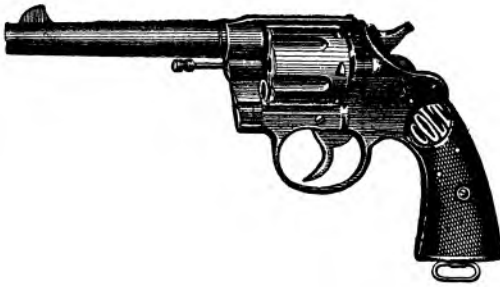
Р и с. 37. Револьвер военного образца сист. Кольта (США) 1917 г., кал. 45 (11,5 мм).
