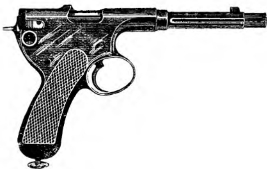
Р и с. 23. Пистолет военного образца сист. Глизенти 1909 г. (Италия), кал. 7,65 мм.
