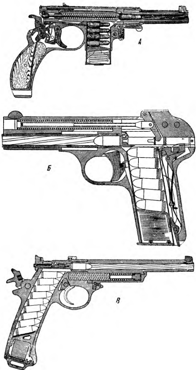
Рис. 16. Схематический разрез, самозарядных пистолетов разных систем: А — Бергмана обр. 1897 г.; Б — Браунинга обр 1897 г.; В — Манлихера обр. 1903 г.
