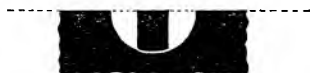
Р и с. 66. Правильное положение мушки в прорези прицела, так называемая „ровная мушка“.
