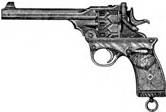
Р и с. 39. Автоматический револьвер военного типа сист. Веблей-Фосбери (Англия), кал. 38 (9 мм).
