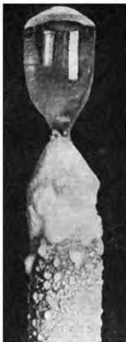
Буля искусственного рубина, выращенная из окиси алюминия на аппарате конструкции советского ученого С. К. Попова. Такие кристаллы нужны часовой промышленности и лазерной технике
