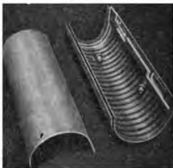
Детали ракеты, сделанные из молибденового сплава
