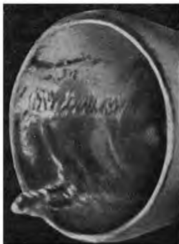
Отложения окиси бора на стенках сопла реактивного аппарата
