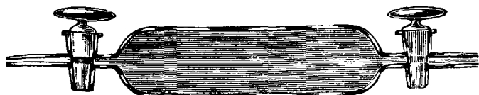
Фиг. 2. Сосуд с притертыми пробками.
