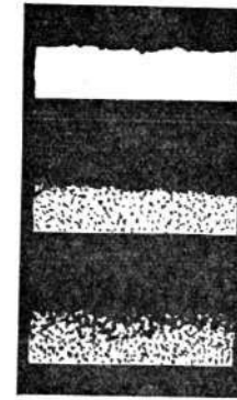
Рис. 11.24. Определение резкости по изображению края лезвия на киноплёнке: 1 — малочувствительная, 2 — среднечувствительная, 3 — высокочувствительная
