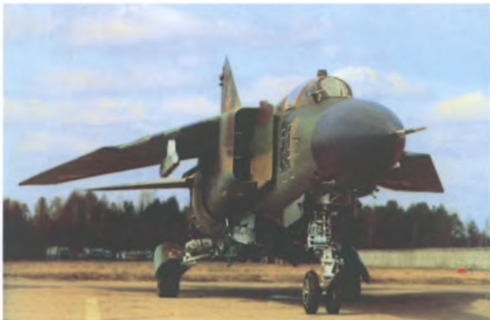
Многоцелевой истребитель МиГ23 из сплава В95 (1973 г.). Применение сплава В95 повышенной чистоты (пч) обеспечило надежность МиГ23
