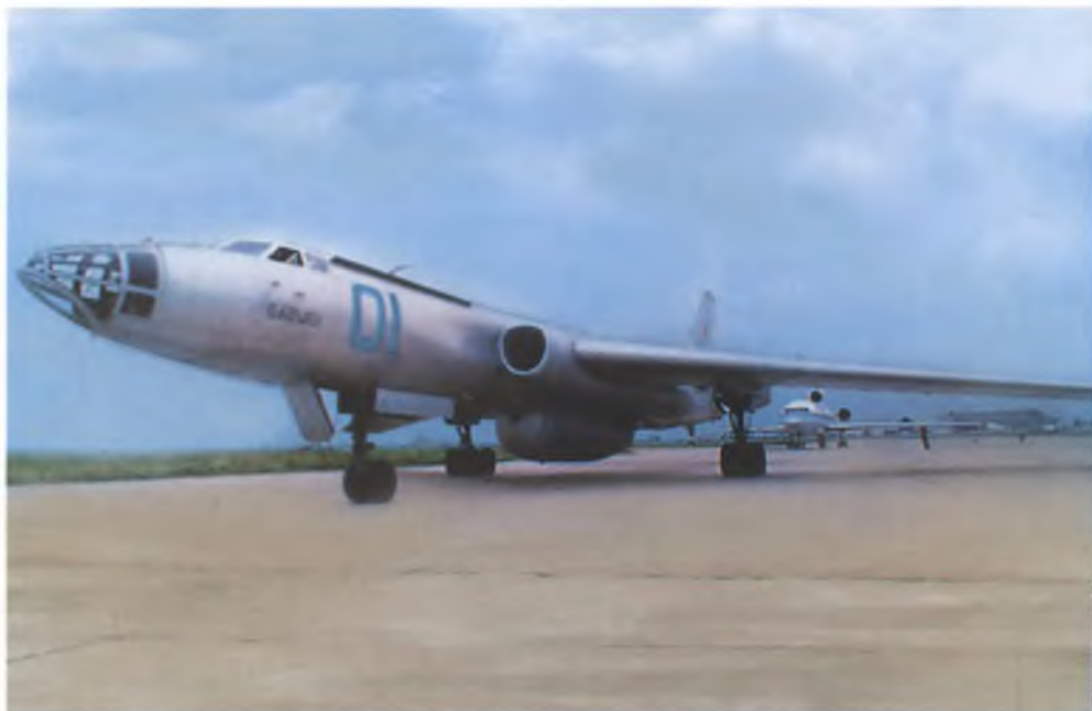
Пикирующий бомбардировщик Ту16 из высокопрочного сплава В95 (1953 г.)
