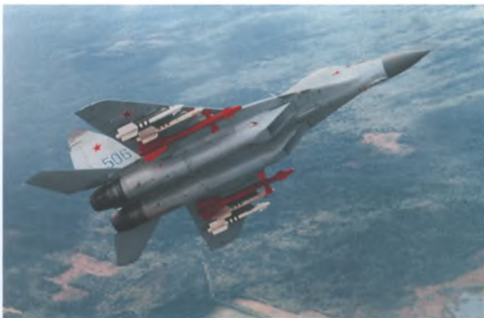
Первый в мире сварной сверхзвуковой истребитель МиГ29 из сверхлегкого Al-Li сплава 1420 (1986 г.). Максимальная скорость на высоте – 2 450 км/ч; практический потолок – 17 000 м; дальность полета (с одним подвесным топливным баком) – 2 100 км; вооружение – пушка калибра 30 мм, управляемые ракеты класса “воздух-воздух”
