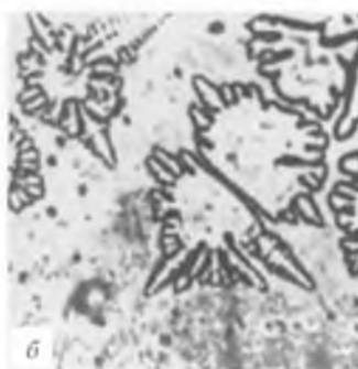
Рис. 5. Структура камфена после охлаждения с высокой скоростью
