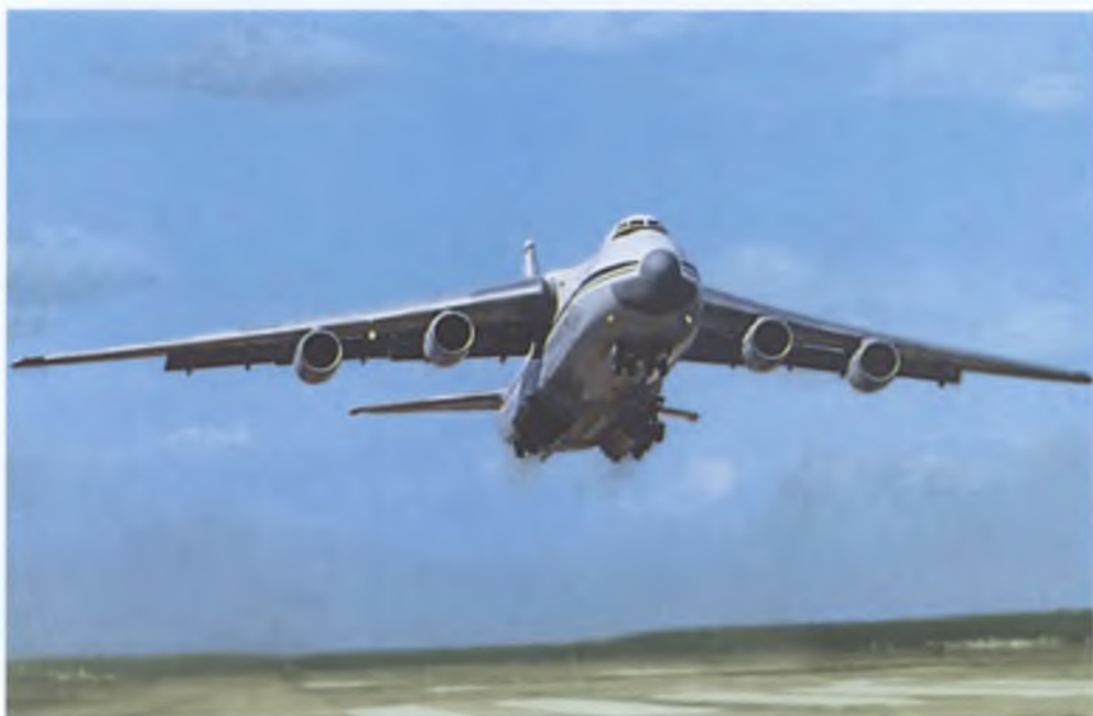
Тяжелый широкофюзеляжный транспортный самолет Ан124 “Руслан” (1983 г.). Вся конструкция изготовлена из высокопрочного кованого сплава В93 и сплава 1933. Максимальная скорость – 865 км/ч; дальность полета – 16 500 км
