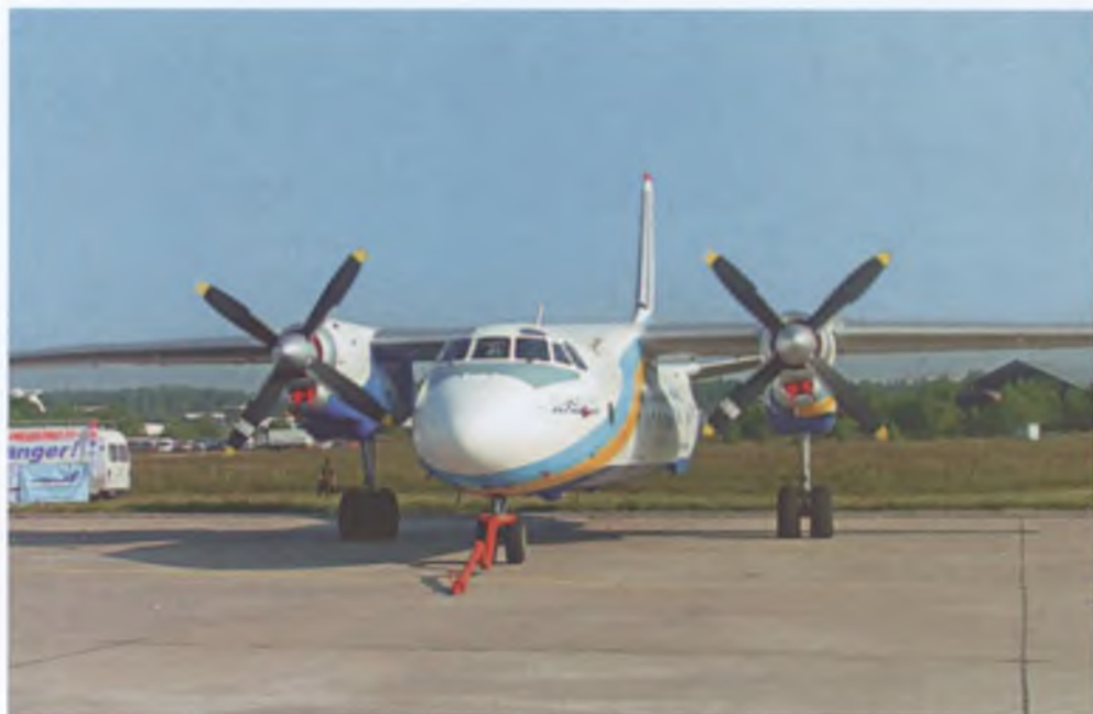
Ан24 – пассажирский самолет. Максимальная скорость – 500 км/ч; практический потолок – 8 400 м; дальность полета – 2 280 км; число пассажиров – 44–50 чел.
