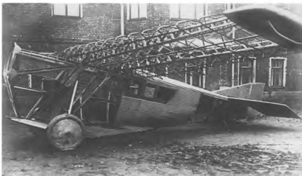
Самолет АНТ2 из алюминиевого сплава дуралюмин совершил первый полет 1 мая 1924 г.
