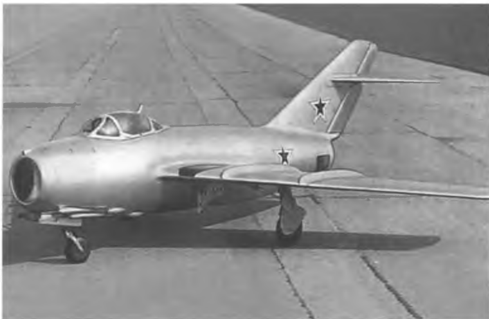
Реактивный истребитель МиГ15 (1947 г.). Максимальная скорость – 1 090 км/ч; практический потолок – 15 500 м; дальность полета – 1 940 км/ч; вооружение – три пушки калибра 37 мм
