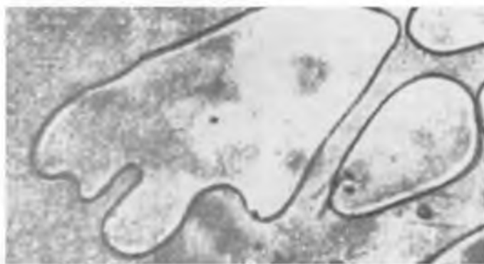
Рис. 4. Образование в камфене первых ветвей (протообразов будущих дендритов) с увеличением скорости охлаждения
