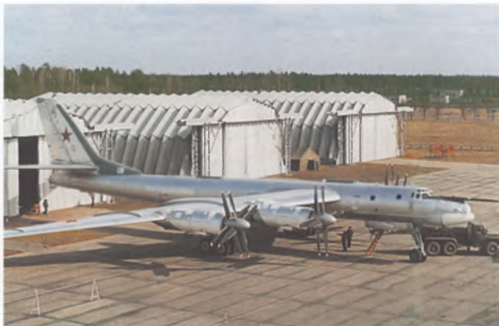
Стратегический бомбардировщик Ту95 (1955 г.). Верх крыла – высокопрочный сплав В95, низ крыла и обшивка фюзеляжа – сплав Д16ч, силовые узлы – сплав В93. Максимальная скорость – 910 км/ч; практический потолок – 9 100 м; дальность полета – 11 000 км; вооружение – две пушки калибра 23 мм, крылатые ракеты, бомбы
