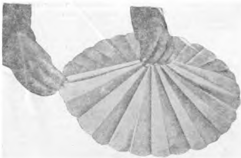
Фиг. 14а. Складывание (фальцовка) купола парашюта.
