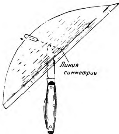
Фиг. 28. Определение центра тяжести модели.
