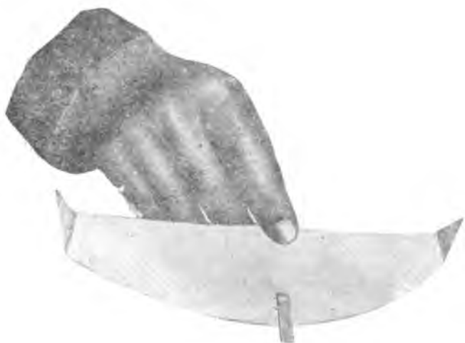
Фиг. 6. Способ запуска модели планера «парабола».
