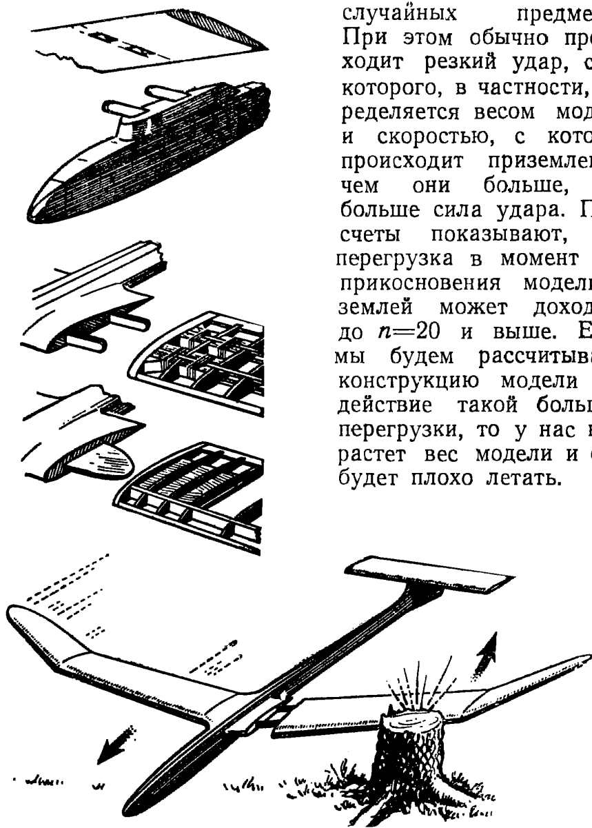
Рис. 65. Саморазъединяющееся крепление крыла
