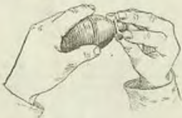
Рис. 76 Ввинчивание дистанционной трубки в гранату 39
