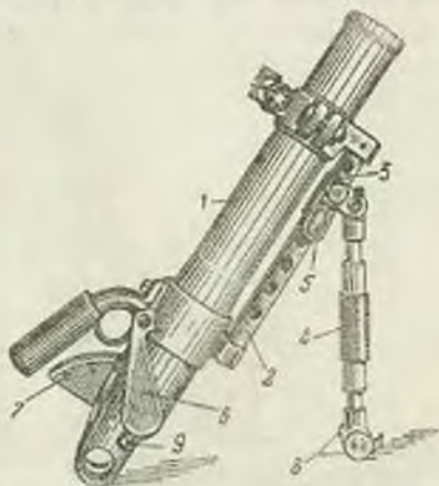
Рис. 82. Ствол с подъемным механизмом 50-мм германского миномета: 1 — ствол; 2 — трубка; 3 — клин; 4 — скользящая муфта лоухомного механизма; 5 — анvil; 6 — скользящая рукоятка стреляющего приспособления; 7 — сектор; 8 — стабилизатор; 9 — щека
