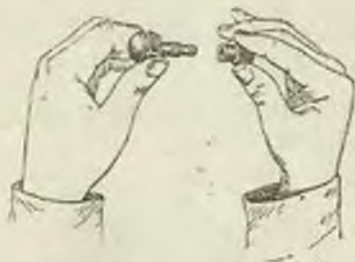
Рис. 74. Отвинчивание предохранительного колпачка дистанционной трубки у яйцевидной ручной гранаты 39
