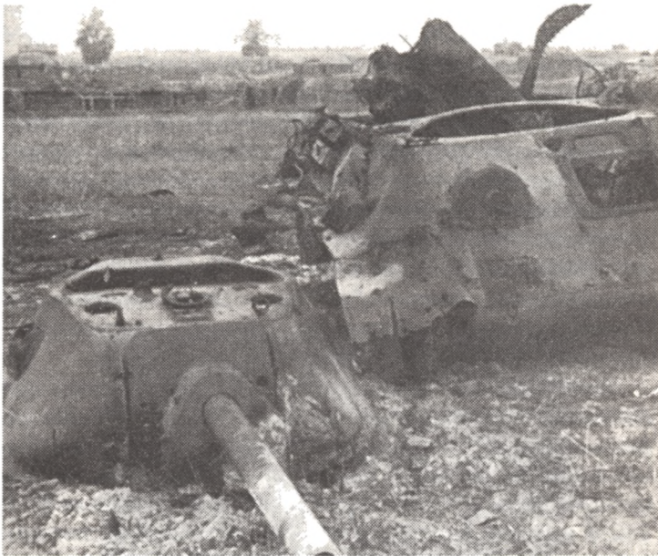
Разрушенный взрывом боекомплекта танк Т-34. Группа армий «Центр», октябрь 1941 г. До определенного момента немецкие командующие танки Т-34 «не замечали».
