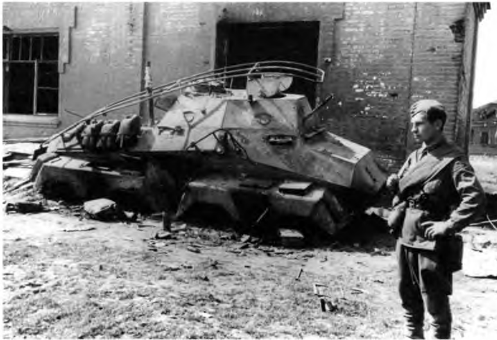
Бронеавтомобиль управления Sd/Ktz.263, подбитый бойцами Юго-Западного фронта. Оснащен поручневой радиоантенной для передатчика дальнего действия. Украина, август 1941 года (АВЛ).
