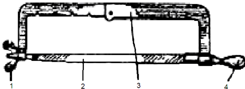
Рис. 3.20. Ножовка по металлу с раздвижной рамкой: 1 – натяжная гайка; 2 – полотно; 3 – скобообразный металлический станок; 4 – ручка
