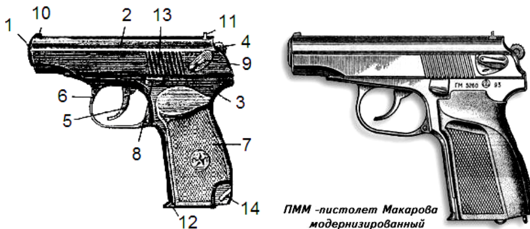
Рис. 4.2. Пистолеты системы «Макарова» (ПМ и ПММ) калибр 9 мм: 1 – ствол; 2 – затвор; 3 – рамка; 4 – головка курка; 5 – спусковой крючок; 6 – спусковая скоба; 7 – рукоятка; 8 – затворная задержка; 9 – флажок предохранителя; 10 – мушка; 11 – целик; 12 – крышка магазина; 13 – насечка; 14 – антабка
