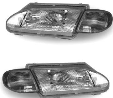
Рис. 2.9. Фарный блок для VAZ 2115
