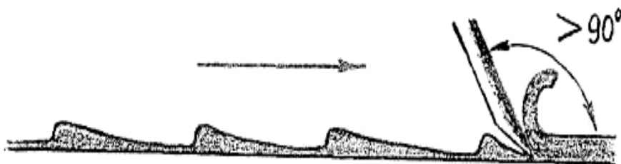
Рис. 3.25. Особенности рельефа динамического следа, образованного режущим предметом при фронтальном угле более 90^\circ (появляются поперечные линии переката)
