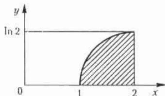
Рис. 7.2. Площадь фигуры, ограниченной графиком функции y = \ln x , осью Ox и прямой x = 2
